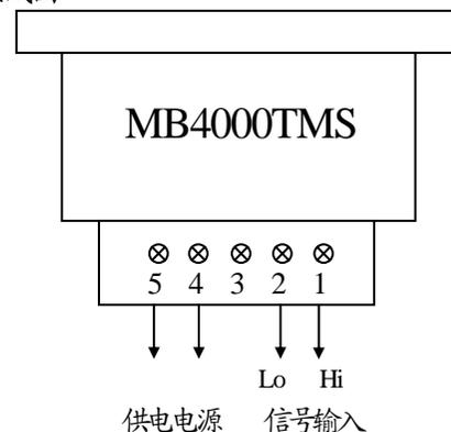
接线端子说明: 1、2 端为信号输入端, 直流输入时 1 端为正, 2 端为负。3 端为空脚。4、5 端为电源输入端, 直流供电时, 4 端为负, 5 端为正。
